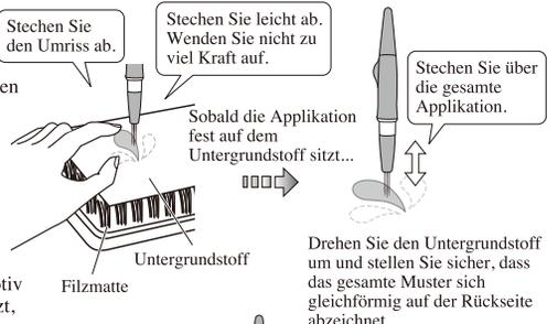
(2) Drücken Sie die Filzwolle oder das Motiv leicht mit dem Finger an und stechen Sie mit der „Stifförmige Trockenfilznadel“ rund um den Rand. Wenn die Filzwolle oder das Motiv fest auf dem Untergrundstoff sitzt, stechen Sie gleichmäßig über die gesamte Oberfläche.
