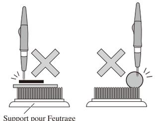
• Ne retirez pas l'aiguille à un angle différent de l'angle d'introduction car cela pourrait entraîner la rupture de l'aiguille.
