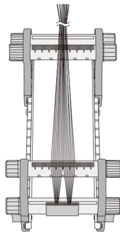
**3** Schieben Sie den Kettfaden-Stopper durch das Loch, welches sich am Rand des Führungs-Kettbaums befindet, über die Fäden.
