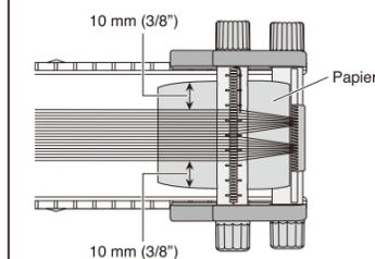
**6** Ziehen Sie die Kettfäden zu sich und befestigen Sie sie mit der Halterung auf dem Wickelbaum. Ziehen Sie erneut an den Kettfäden, um zu prüfen, ob diese unter der Halterung bleiben. Kürzen Sie die Kettfäden auf etwa 5 mm (1/4").
