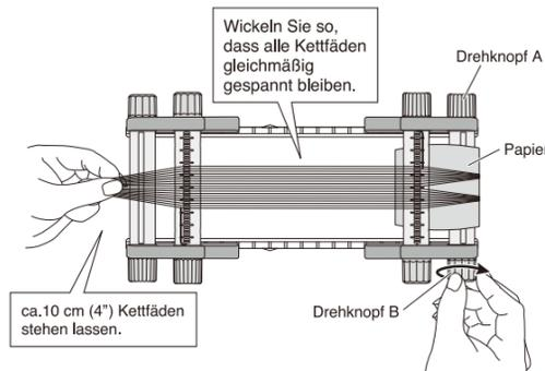
Um ein gleichmäßiges Wickeln der Kettfäden zu gewährleisten, legen Sie vor dem Aufwickeln der Fäden ein Blatt Papier auf den Wickelbaum. Ein Blatt mit einer Breite der Kettfäden plus beidseitig 10 mm (3/8") und einer Länge von 15 cm (6"). Sobald das Papierende während des Wickelns den Baum erreicht hat, legen Sie ein weiteres Blatt Papier nach und fahren Sie fort.
