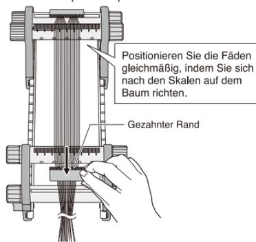
**5** Wickeln Sie die Kettfäden mit \*Papier auf. Lösen Sie Drehknopf A des Wickelbaums, der durch die Halterung gesichert ist, drehen Sie dann Drehknopf B und ziehen Sie an den gespannten Fäden. Wickeln Sie, bis noch ungefähr 10 cm (4") Kettfäden-Reste auf dem gegenüberliegenden Führungs-Kettbaum übrig bleiben.
