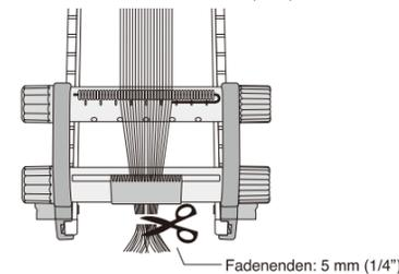
**7** Wickeln Sie die Kettfäden 1,5 Mal um den Wickelbaum, der vor Ihnen steht. Lösen Sie den Drehknopf A auf beiden Wickelbäumen und drehen Sie dann Drehknopf B auf dem Wickelbaum vor Ihnen. Stellen Sie die Spannung der Kettfäden und ziehen Sie Drehknopf A auf beiden Wickelbäumen an.
