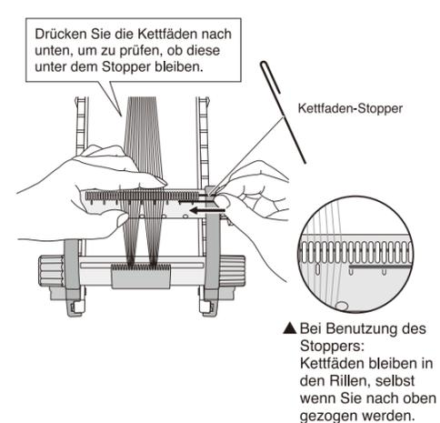
**4** Drehen Sie den Webrahmen so, dass sich die gegenüberliegenden Bäume nun vor Ihnen befinden, kämmen und trennen Sie die Kettfäden mit dem gezahnten Rand der Halterung und stecken Sie die Fäden in die Rillen des gegenüberliegenden Führungs-Kettbaums. Schieben Sie den Stopper in das Loch am Rand des Baums, nachdem alle Fäden passend positioniert wurden.
