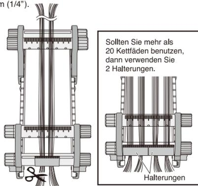
**2** Positionieren Sie jeden Kettfaden in eine Rille des Führungs-Kettbaums.
