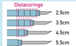
Die Größe der Schlaufe kann angepasst werden, indem die Distanzringe am Griff zur Einstellung der Nadellänge verwendet werden.
